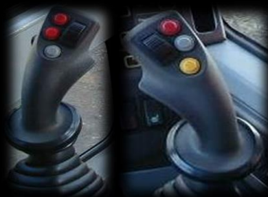
Dois Joysticks com 4 botões cada permitem operar o cabeçote e a escavadeira
